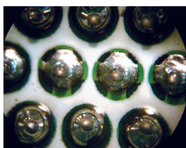
回流后的锡膏和预成型焊片
